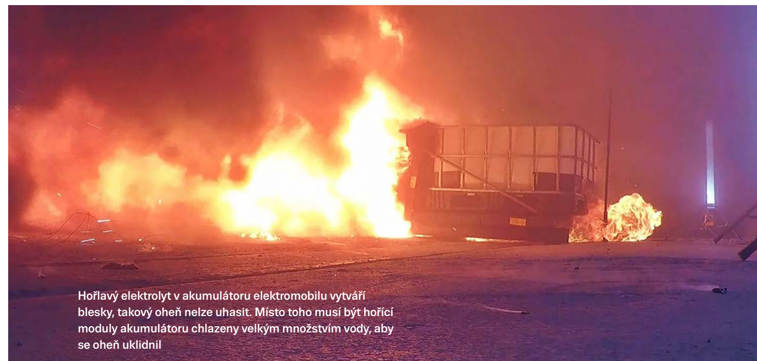
Během požáru se v modulu akumulátoru elektrického automobilu vyvíjí velké množství sazí, které obsahují toxické oxidy kovů
