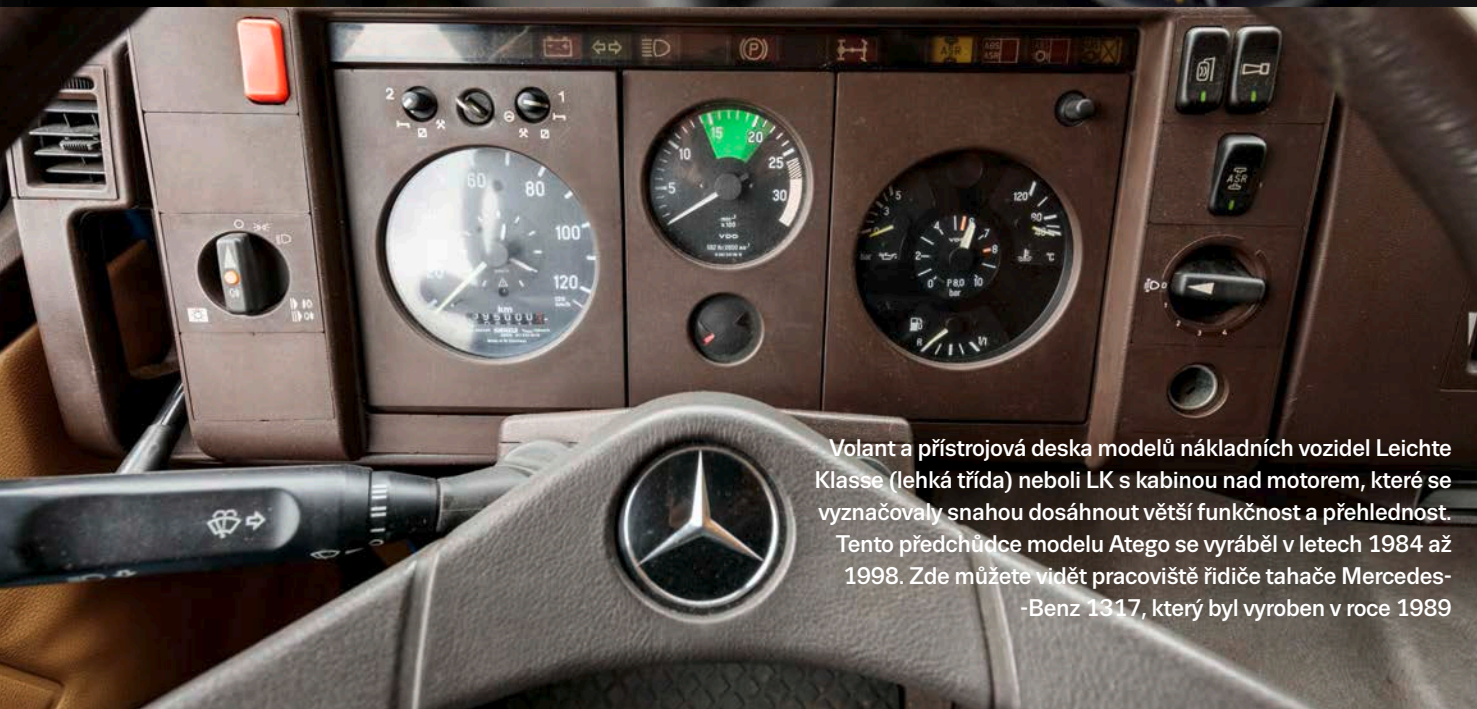
V tomto lehkém sklápěči Mercedes-Benz LPK 813 z roku 1985 bylo kdysi vysoce moderní pracoviště s ergonomicky optimalizovaným volantem a jasným sdružením spínačů a přístrojů
