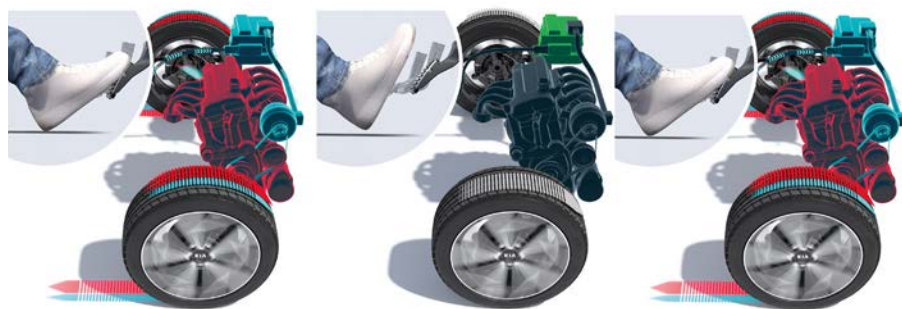
Ústrojí iMT automobilky Kia zachovává zažitý způsob ovládání jako u klasické přímo řazené převodovky se spojkovým pedálem a ručním řazením
