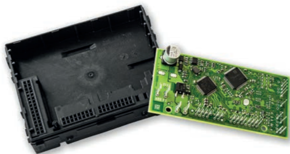
Řídicí jednotka dveří zevnitř – pouzdro ukrývá desku s tištěnými spoji, odpory, polovodiči, čipy apod.
