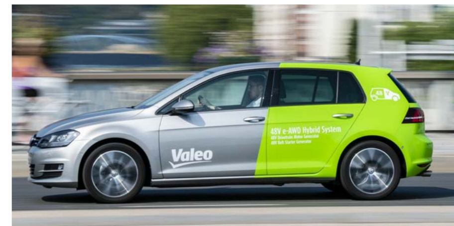
Testování hybridního systému pohonu všech kol 48 V e-AWD se startér/generátorem iBSG
