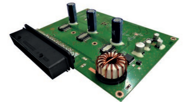
Řídicí jednotka zesilovače má na starosti zpracování zvuku a jeho převod z digitální do analogové podoby a následné zesílení
