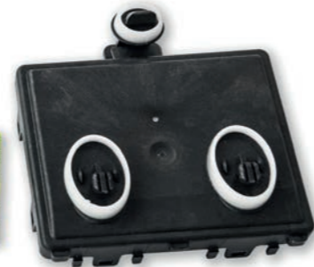
Řídicí jednotka dveří zevnitř – pouzdro ukrývá desku s tištěnými spoji, odpory, polovodiči, čipy apod.
