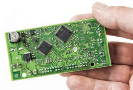
Deska s tištěnými spoji, rezistory a čipy, tuto konkrétně najdete v řídicí jednotce dveří
