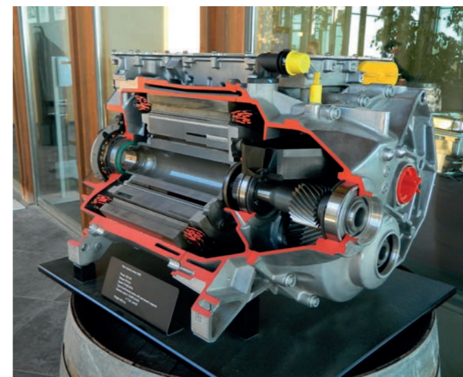
Základem pohonu je synchronní elektromotor MEB s permanentními magnety uložený u zadní nápravy
