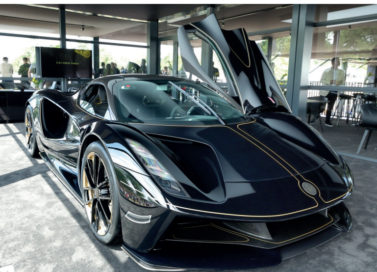
Lotus Evija – elektricky poháněný supersport se čtyřmi trakčními elektromotory pro individuální pohon každého kola s celkovým výkonem 1500 kW
