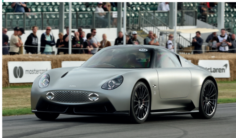
AIM EV Sport 01 je první vůz firmy navržený bývalým designérem Nissanu Širo Nakamurou se dvěma elektromotory na zadní nápravě s celkovým výkonem 355 kW
