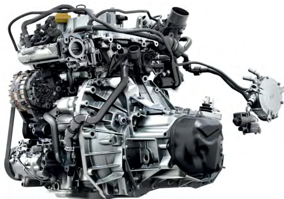
Motor TCe 100 Eco-G verze E2 ve vozech Dacia má oddělený palivový systém pro LPG a benzin
