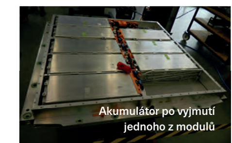
Vysokonapěťový akumulátor připravený k výměně modulu
