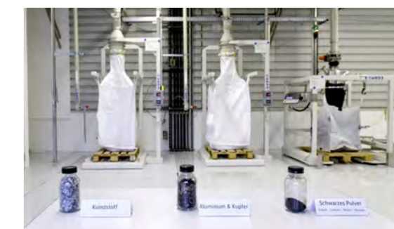
Získaný prášek se plní do pytlů – zleva plasty, hliník a měď, černý prášek (kobalt-lithium, nikl-mangan)
