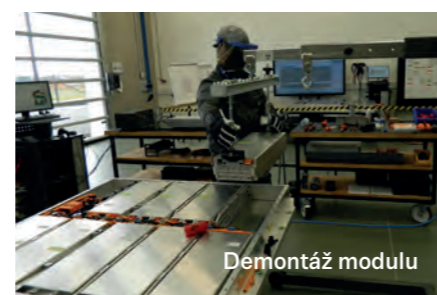
Odpojování modulu pomocí speciálního nářadí
