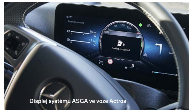
Displej Mercedesu-Benz Actros informuje řidiče o nouzovém zastavení vozidla
