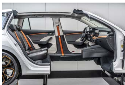
Podlaha a pravá bočnice byly z tohoto takzvaného demonstračního vozu odstraněny s cílem umožnit designérům a konstruktérům ničem neomezený pohled do interiéru
